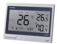
屋内の暑さ指数(WBGT指数)と4段階の注意レベルの表示、温度、湿度を 測定する卓上・壁掛け用の測定器です。設定した暑さ指数を超えるとブザー音 と光(LED)でお知らせします。屋内使用専用です。電波時計機能付。
